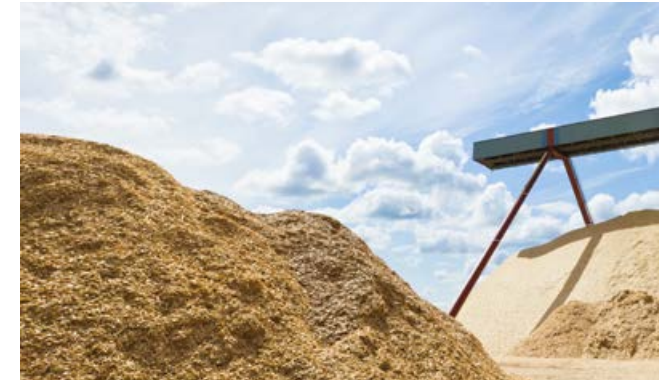
Kiefer, Fichte, Birke und Eukalyptus sind die Rohstoffe für unseren Sulfatzellstoff. Dafür wird das Holz entrindet und zu Hackschnitzeln verarbeitet. Auf dem Foto sind die Lager für Kiefern-, Fichten- und Birkenhacksel im Zellstoffwerk UPM Kymi in Finnland zu sehen.
